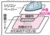
補修する箇所よりすこし大きめにカットした接着シート、補修布を補修箇所に置きシリコンペーパーの上からアイロン接着すればできあがり。
