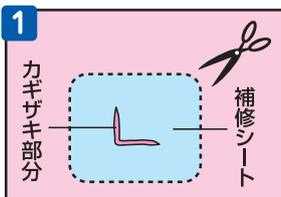
補修する箇所より少し大きめにカットしてください。角を丸くカットすると接着後、剥がれにくくなります。
