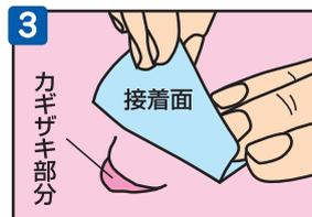
補修シート裏面の紙を剥がして接着面にしわができないように貼り合わせてください。表面から圧力を加えて、完全に接着させてください。
